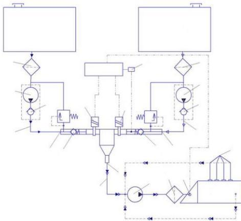
Рисунок 1. Двухтопливная система питания дизеля (обозначение позиций в тексте)
